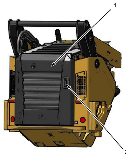
Рисунок 1 (1) Технологический люк двигателя (2) Доступ с помощью рычажного фиксатора
